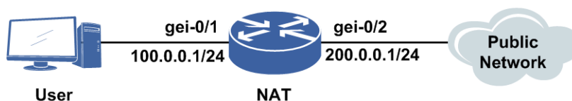
图 13-8 VPN（公网—私网）NAT44 配置实例组网图
