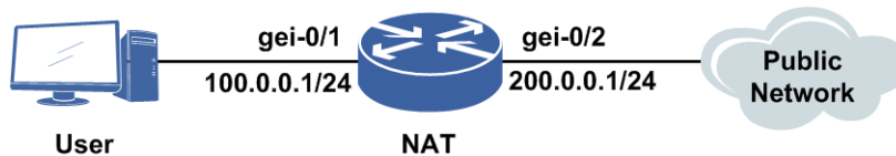
图 13-5 VPN（私网—公网）NAT44 配置实例组网图
